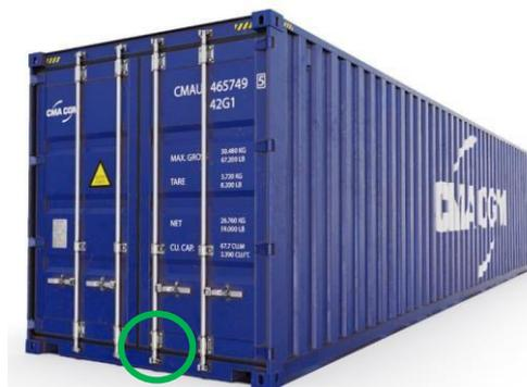
Sendo aceitável que o lacre seja inserido na alavanca juntamente ao trinco fixo da terceira barra haste direita, também com a tampa enumerada voltada para cima.
